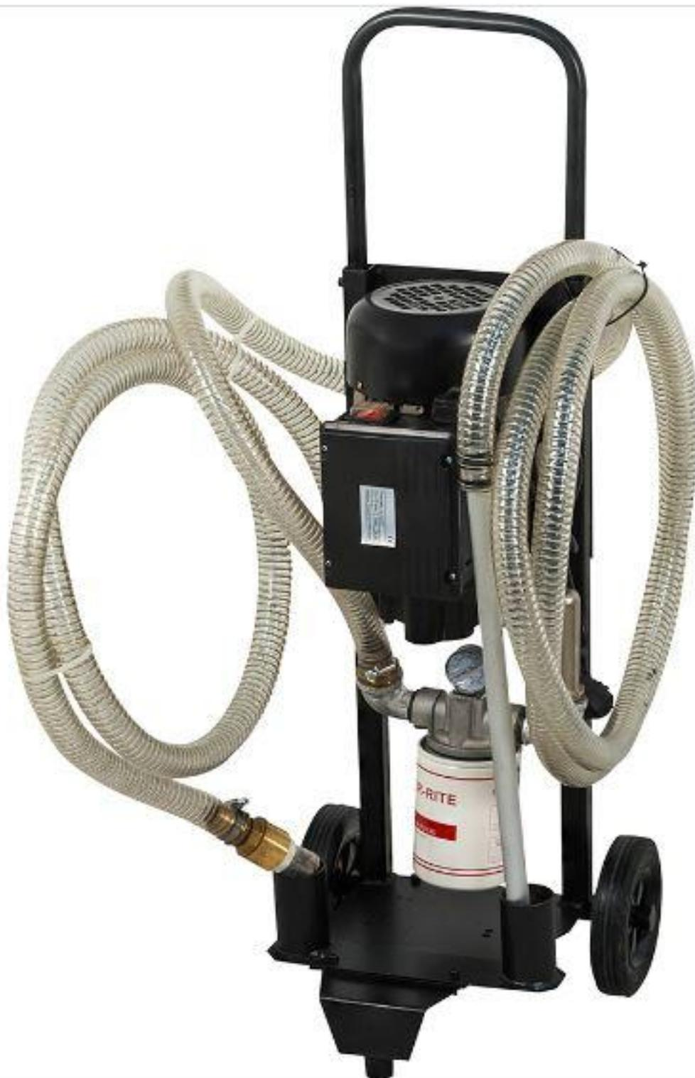
La unidad de filtración se compone de una bomba volumétrica de paletas que aspira el aceite a purificar, enviándolo a través de un filtro de cartucho de alta capacidad que elimina las impurezas.
